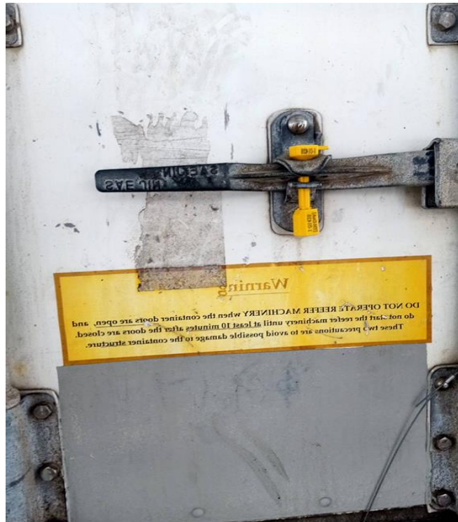
แผนภาพที่ 3-24 ภาพแสดงตัวอย่างการถ่ายภาพ seal ล็อคตู้คอนเทนเนอร์
