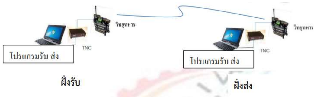
แผนภาพที่ 2 -35 การติดต่อสื่อสารผ่านระบบวิทยุทหาร
