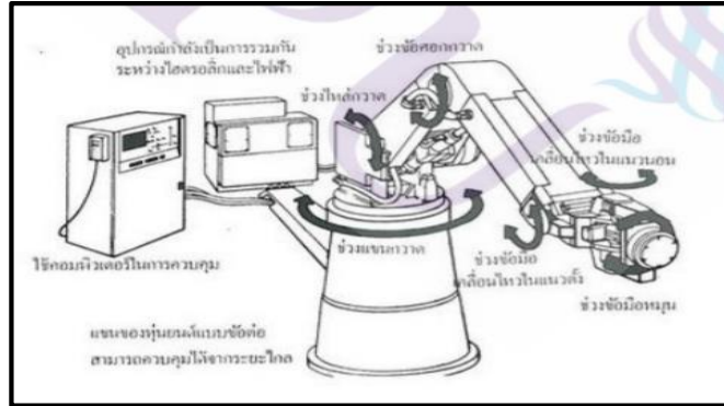
แผนภาพที่ ๓ - ๑๒ แสดงหลักการดำเนินงานของหุ่นยนต์อุตสาหกรรม
