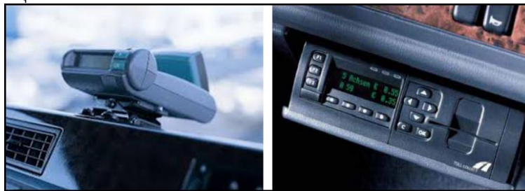
แผนภาพที่ 3-14 อุปกรณ์ติดตั้งบนยานพาหนะ (OBU) แบบใช้บัตรเติมเงินของระบบ EURO Vignette
