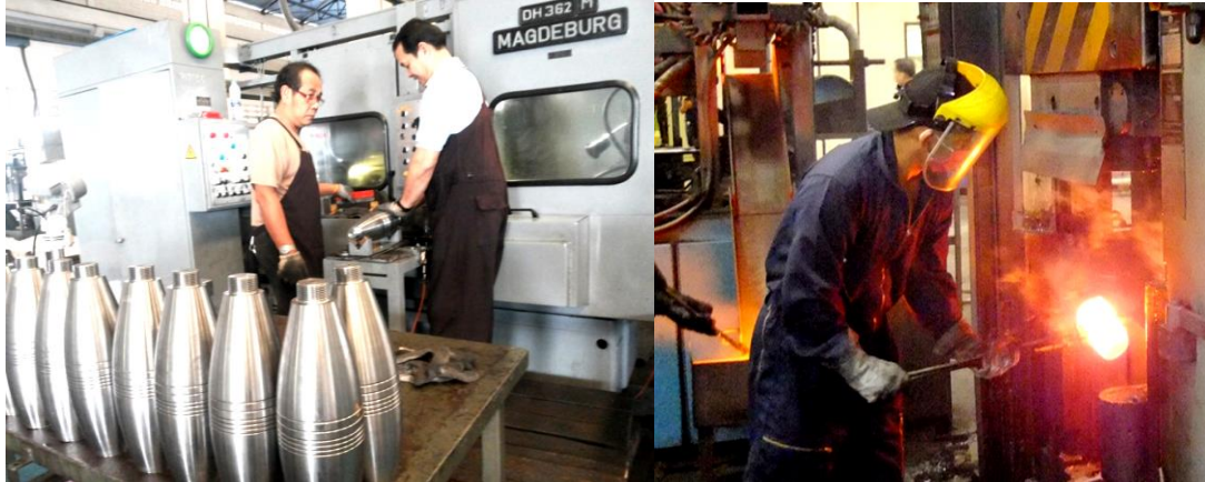
แผนภาพที่ 2-3 สายการผลิตกระสุนของงานผลิตกระสุนปืนใหญ่และเครื่องยิงลูกระเบิด
