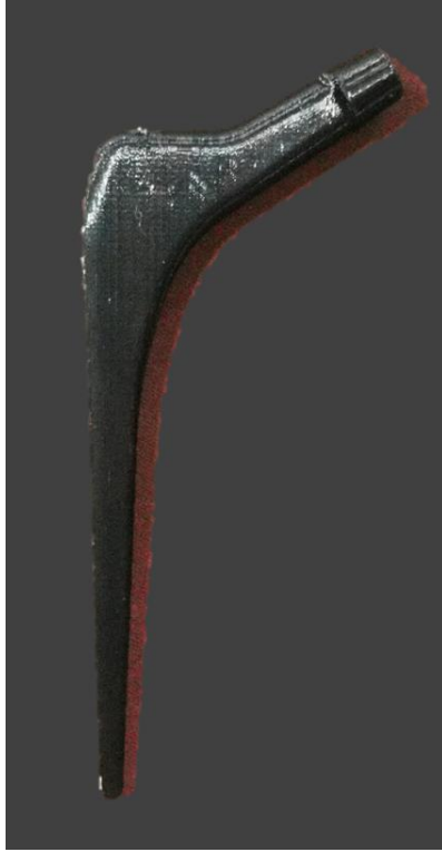
แผนภาพที่ ๓ - ๑๕ การทดสอบการผลิตหัวกระดูกต้นขาด้วยเทคโนโลยีการพิมพ์ ๓ มิติ
