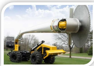
รถตัดต้นไม้ชนิดมิโบลี้อยู่ประกอบกับเครน
