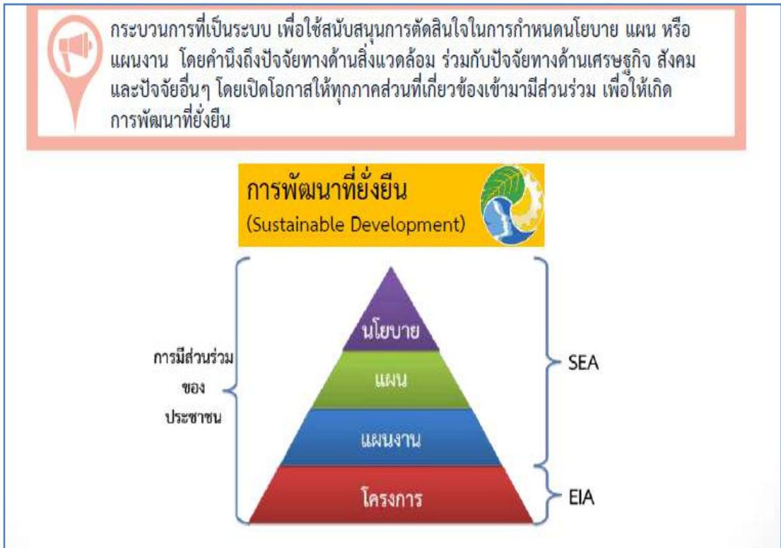
แผนภาพ๒-๖ แสดงความแตกต่างระหว่าง SEA กับ EIA ในระดับขั้นการตัดสินใจ
