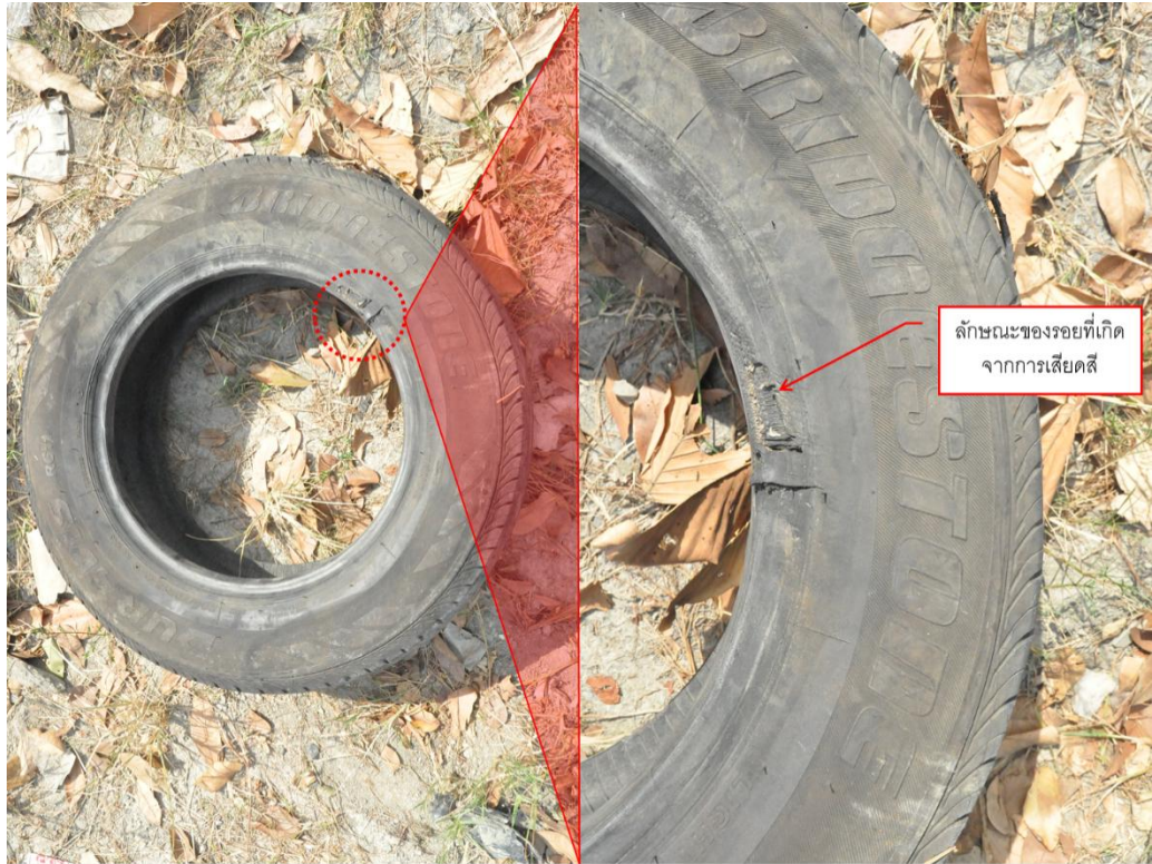
แผนภาพที่ 4-26 ร่องรอยความเสียหายที่ยางหน้าด้านซ้ายบริเวณแก้มยาง
