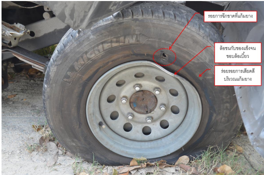
แผนภาพที่ 4-27 ร่องรอยความเสียหายที่ล้อและยางหลังด้านซ้าย
