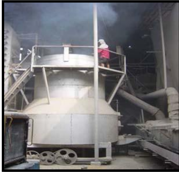
แผนภาพที่ ๒ - ๑๔ การผลิตไฟฟ้าระบบแก๊สซิฟิเคชัน
