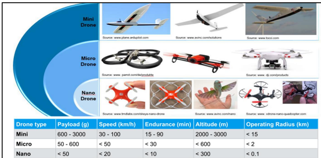
แผนภาพที่ ๒ - ๑ คุณลักษณะของอากาศยานไร้คนขับขนาดเล็ก
