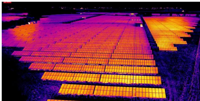
แผนภาพที่ ๒-๑๕ แสดงการใช้อากาศยานไร้คนขับตรวจสอบแผงโซลาร์เซลล์
