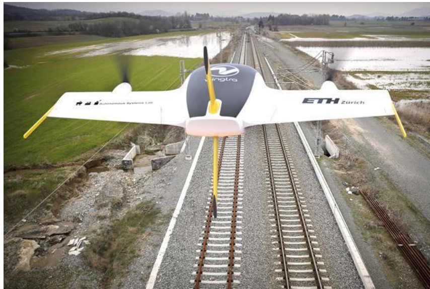
แผนภาพที่ ๒-๑๔ แสดงการใช้อากาศยานไร้คนขับตรวจสอบเส้นทางรถไฟ
