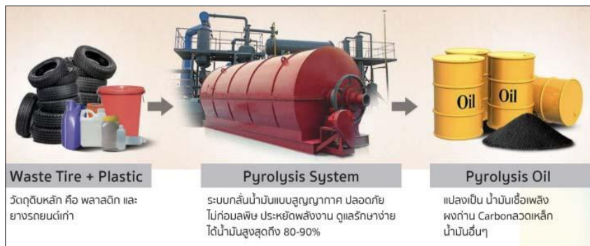
แผนภาพที่ ๒-๘ การแปรรูปขยะพลาสติกเป็นน้ำมันเชื้อเพลิง Pyrolysis Conceptual
