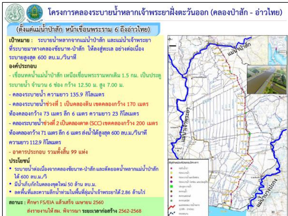
ภาพที่ ซ-๕ สรุปโครงการคลองระบายน้ำหลักเจ้าพระยาฝั่งตะวันออก (คลองชัยนาท-ป่าสัก)
