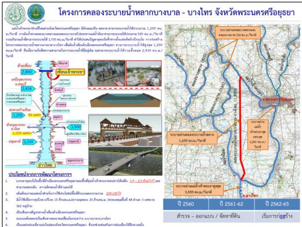
ภาพที่ ช-๒ ข้อมูลโครงการคลองระบายน้ำหลากบางบาล-บางไทร จ.พระนครศรีอยุธยา
