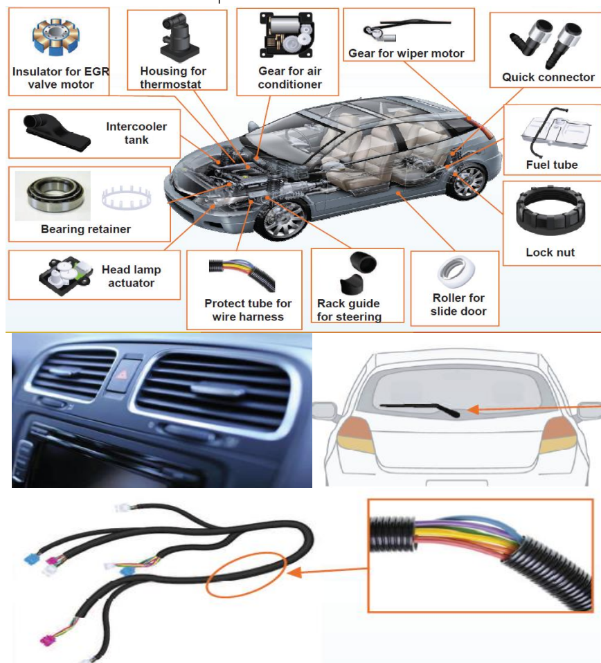
แผนภาพที่ 3-27 ตัวอย่างของชิ้นส่วนต่างๆของรถยนต์สมัยใหม่ที่ทำมาจากผลิตภัณฑ์ปิโตรเคมี
