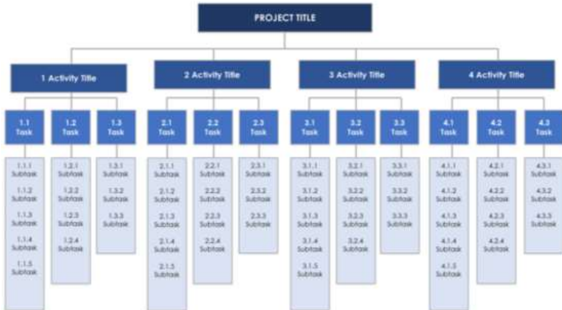
แผนภาพที่ 2-18 : ตัวอย่างการแตกโครงสร้างของงาน
