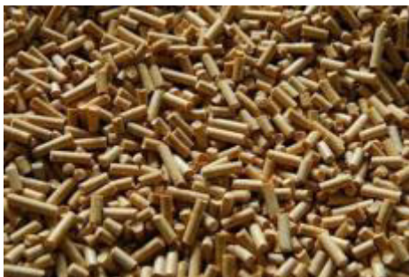
แผนภาพที่ ๓-๔๐ ขยะมูลฝอยที่ผ่านการอัดด้วยเครื่อง Pellet
