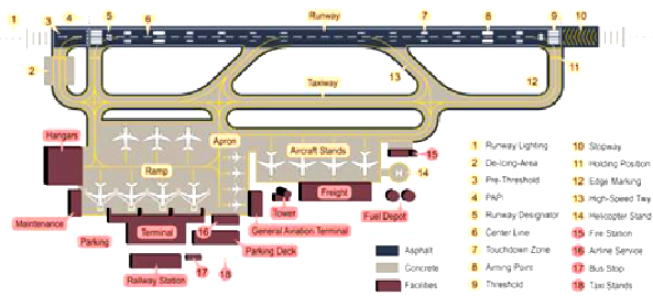
แผนภาพที่ ๒ - ๔ องค์ประกอบของท่าอากาศยาน
