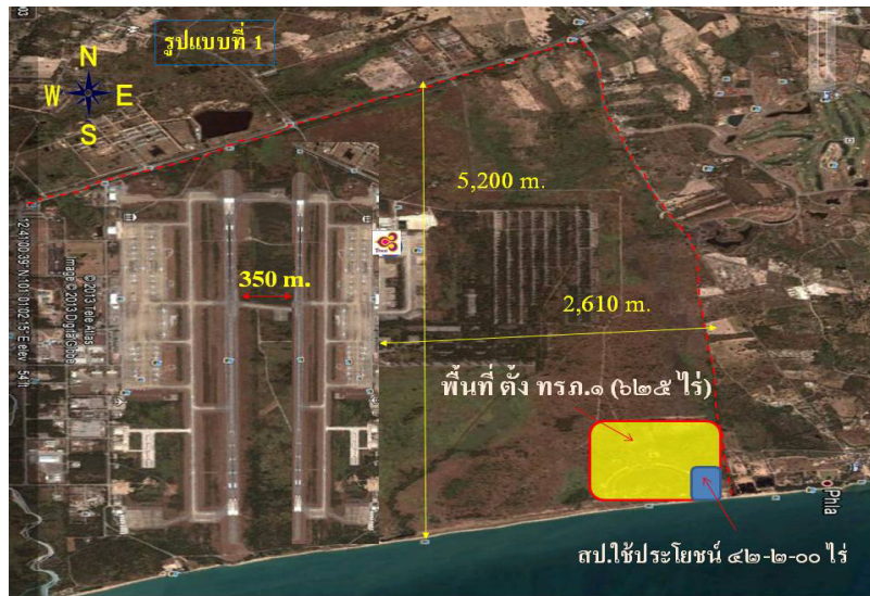
แผนภาพที่ ๔ - ๗ ภาพจำลองทางวิ่งสองทางวิ่งในลักษณะชิดกันภายในสนามบินอู่ตะเภา
