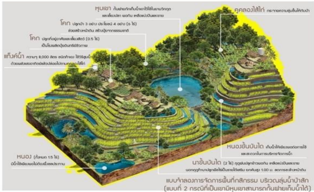
แผนภาพที่ 3-4 : แบบจำลองกรณีเป็นเขามิหุบเขาสามารถกั้นฝายเก็บน้ำได้
