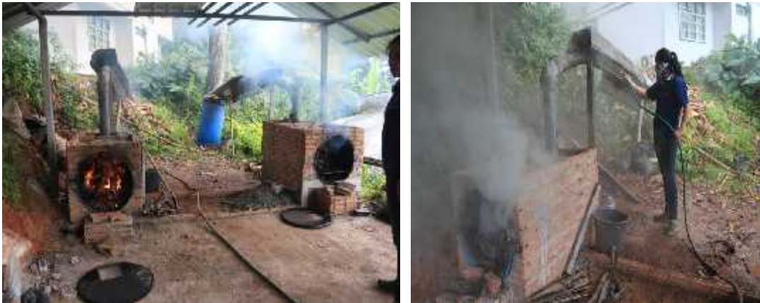
3-27 ภาพขั้นตอนการเผาถ่านไม้ เพื่อนำผลผลิตมาทำน้ำส้มควันไม้
