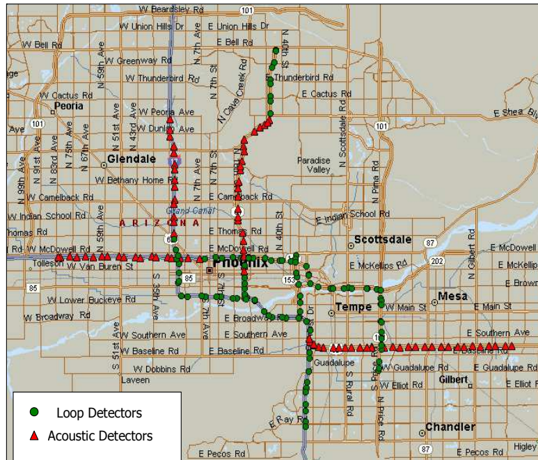
แผนภาพที่ 4-26 : แสดงตำแหน่งการติดตั้งอุปกรณ์ตรวจวัดสภาพจราจรบน Freewayเมืองฟีนิกซ์รัฐแอริโซนา
