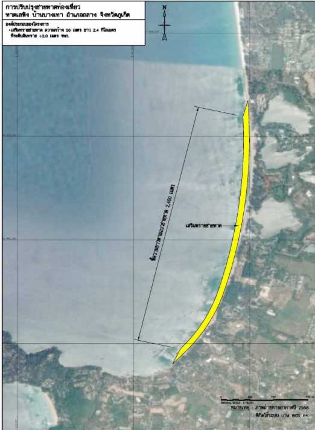
แผนภาพที่ ๓-๔๓ รูปแบบการแก้ปัญหาการกัดเซาะชายฝั่งของหาดเลพัง จังหวัดภูเก็ต
