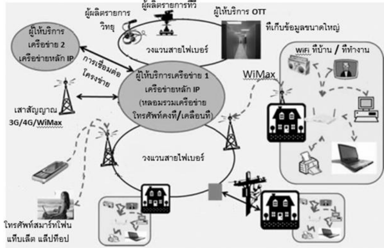
แผนภาพที่ 2.21 แสดงบริการต่างๆบนเครือข่ายที่หลอมรวมกัน หรือ “Converged Network”
