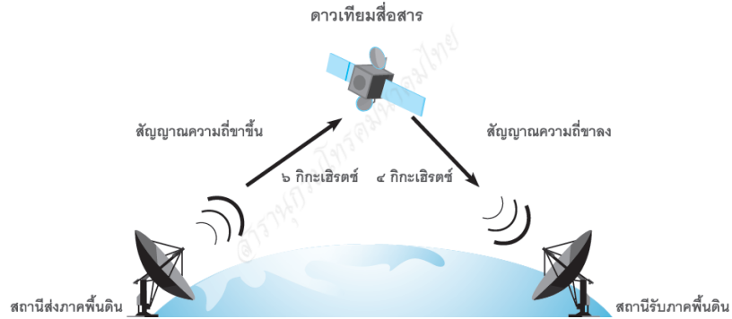
แผนภาพที่ ๒-๑ แสดงพื้นฐานตัวอย่างการสื่อสารผ่านดาวเทียมย่านความถี่ซีแบนด์ (C-Band)
