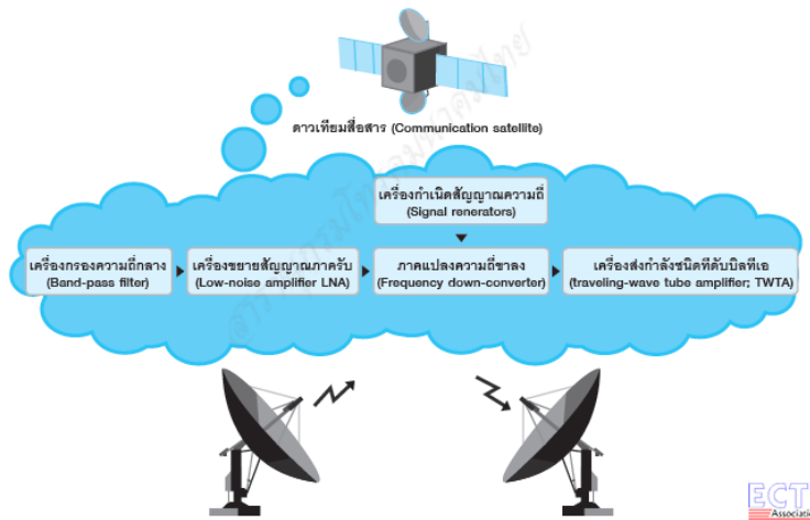
แผนภาพที่ ๒-๒ องค์ประกอบหลักของช่องสัญญาณดาวเทียมสื่อสาร
