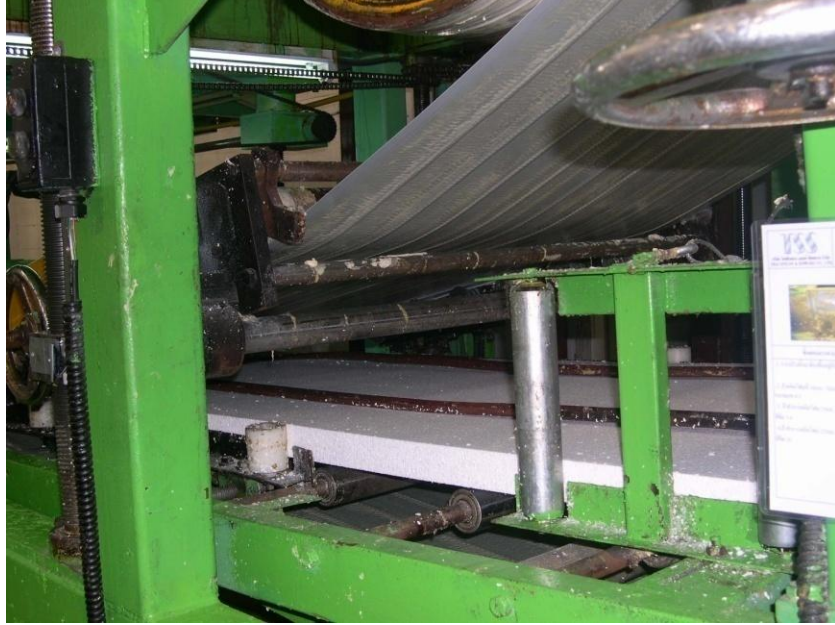
แผนภาพที่ 3-3 เครื่องรีดแผ่นเหล็กกล้าประกบแผ่น โพลีสไตรีน โฟมแบบ Sandwich Panel
