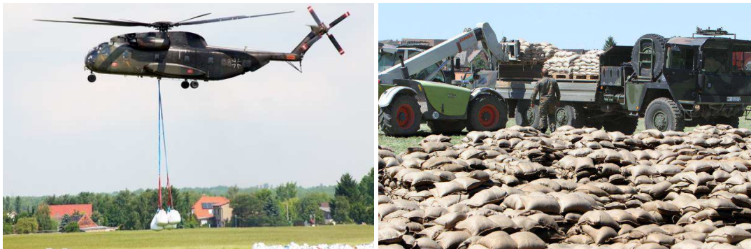
แผนภาพที่ 4-29 การใช้ยานพาหนะทางทหารขนย้ายกระสอบทรายเพื่อสร้างแนวกันกั้นน้ำ
