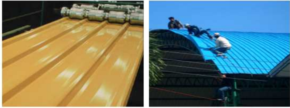
รูปที่ 1.7 หลังคาเคลือบอลูซิงค์รีดลอน
