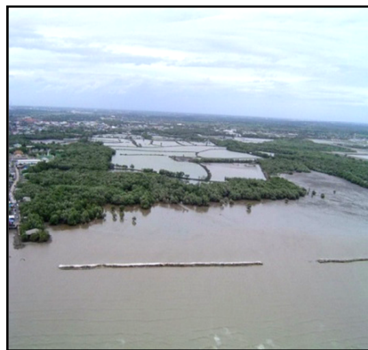
แผนภาพที่ 2 - 9 การใช้ไส้กรอกทรายเป็นแนวป้องกันและแก้ไขปัญหาการกัดเซาะบริเวณชายฝั่งทะเล อำเภอลองด่าน จังหวัดสมุทรปราการ
