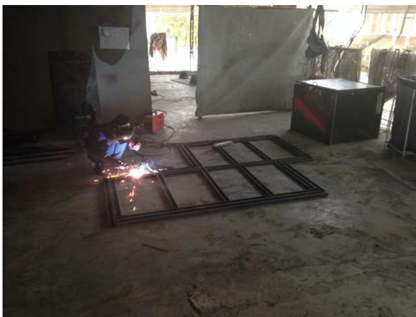
แผนภาพที่ 4-4 การเชื่อม โครงเหล็กสำหรับใช้เป็น โครงสร้างพื้นห้องน้ำสำเร็จรูป
