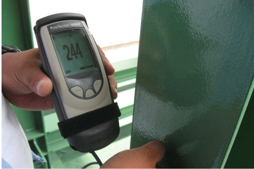
แผนภาพที่ 2-6 การควบคุมคุณภาพโดยการตรวจสอบความหนาของสีที่โรงงาน
