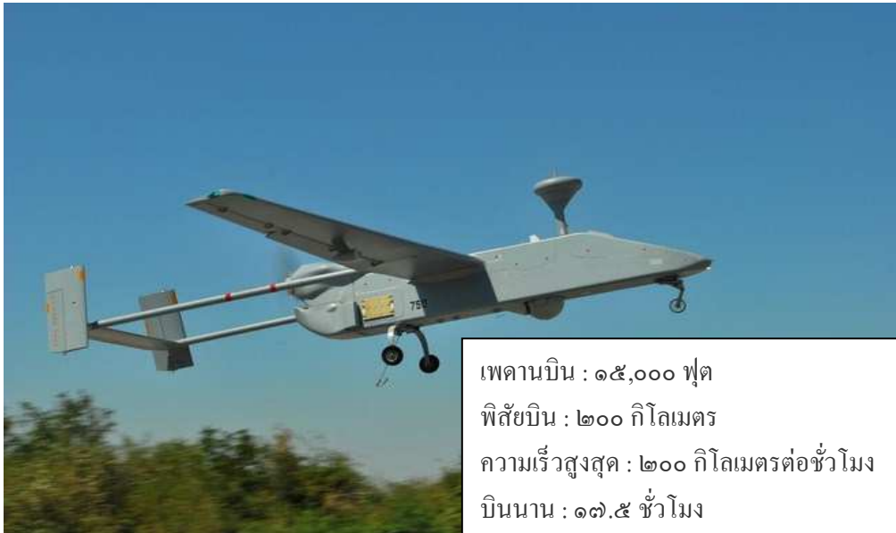
แผนภาพที่ ๒-๘ อากาศยานไร้คนบินแบบ Searcher MK – II
