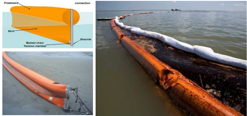
แผนภาพที่ ๒ - ๑๐ การควบคุมและจำกัดพื้นที่ของการปนเปื้อนโดยทุ่นกักน้ำมัน
