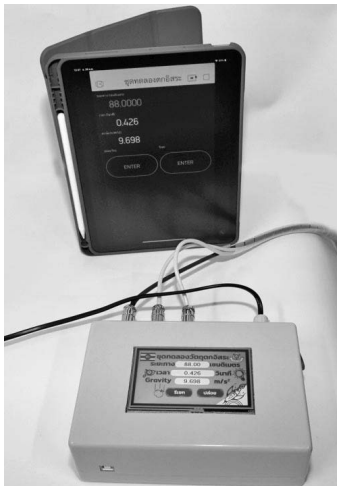
ภาพที่ 7 ภาพการแสดงผลข้อมูลการทดลองควบคุมโดยไมโครคอนโทรลเลอร์
