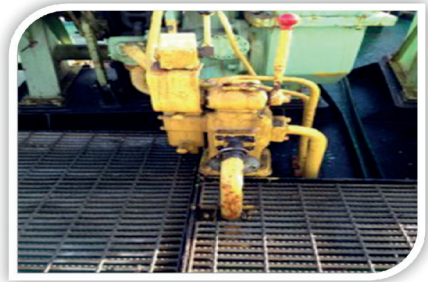
ภาพที่ 6 โจรสลัดทำลายท่อไฮโดรลิค และเครื่องก้วานสมอเรือ
